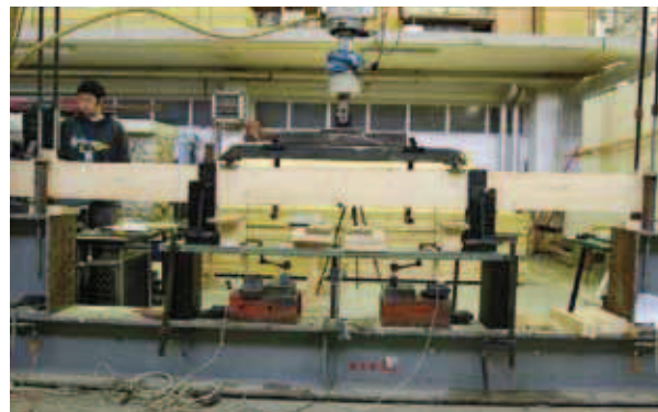
Slika 5. Vzorec dimenzij 44 mm x 210 mm med upogibno preiskavo
